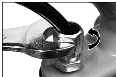
②続いて8mmのスパナを使ってブレーキ調節ネジ（上段）を反時計方向に回します。
