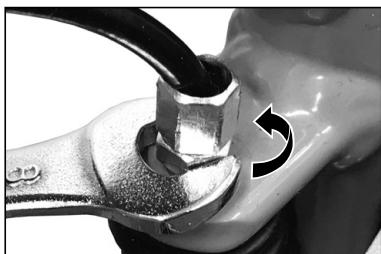
①8mmのスパナを使って固定ナット（下段）を反時計方向にゆります。
